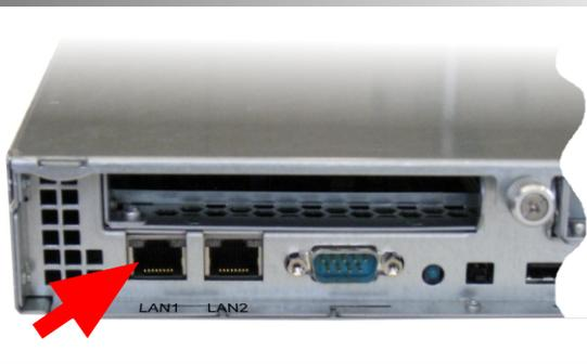
Für den Betrieb im Netzwerk verbinden Sie das Netzwerk-kabel mit dem LAN-Anschluss 1 und Ihrem Router oder Switch. Schalten Sie nun C-MOR mit dem Schalter an der Vorderseite ein. Die voreingestellte IP-Adresse 192.168.1.2 kann über die VGA-Konsole oder über das IPSetup Tool geändert werden.
